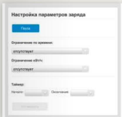
В данном подразделе можно начать заряд (кнопка «Начать»), остановить заряд (кнопка «Пауза»), установить ограничение заряда по времени или потребленной мощности, а также выставить таймер заряда, указав временной диапазон.
